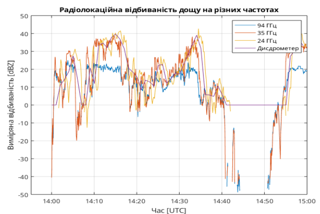
Рис. 5. Часові залежності еквівалентної радіолокаційної відбиваності Z_e дощу на висоті приблизно 250 м, виміряної одночасно у К-, Ка- та W-діапазонах протягом однієї години
