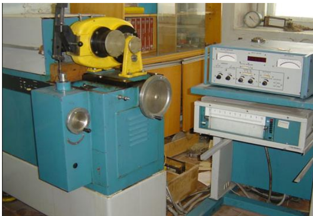
Рис. 2. Камера машини СМЦ-2 для випробування зразків у різних середовищах
