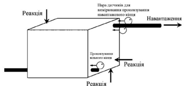
Рис. 5. Схема модифікованого випробування кінців балок для дослідження зчеплення арматури з бетоном [22]
