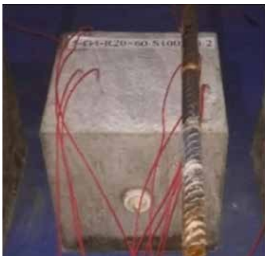
Рис. 10. Типові схеми руйнування експериментальних зразків за висмикування арматурного стержня з бетонного блоку [12]: а) схема руйнування типу висмикування; б) схема руйнування типу розколювання
