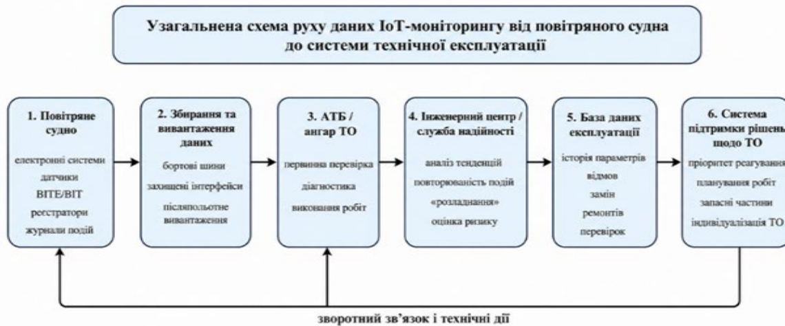
Рис. 1. Узагальнена схема руху даних IoT-моніторингу від повітряного судна до системи технічної експлуатації
