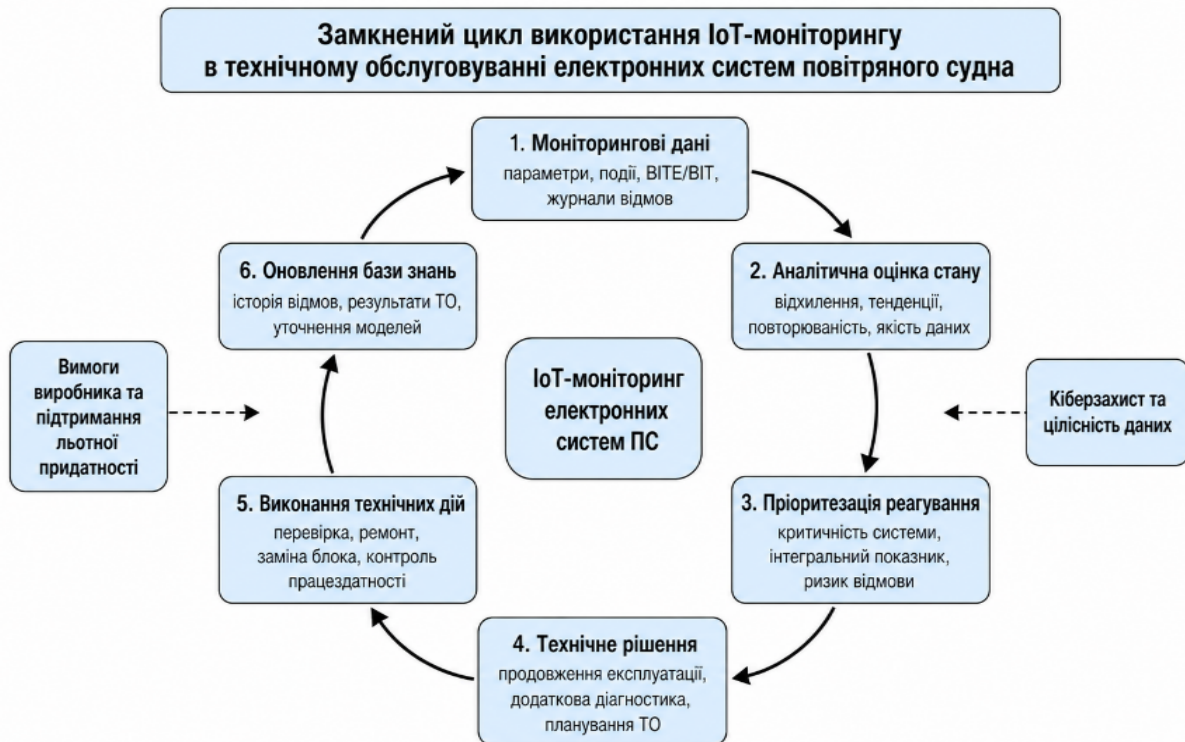
Рис. 2. Замкнений цикл використання IoT-моніторингу в технічному обслуговуванні електронних систем повітряного судна
