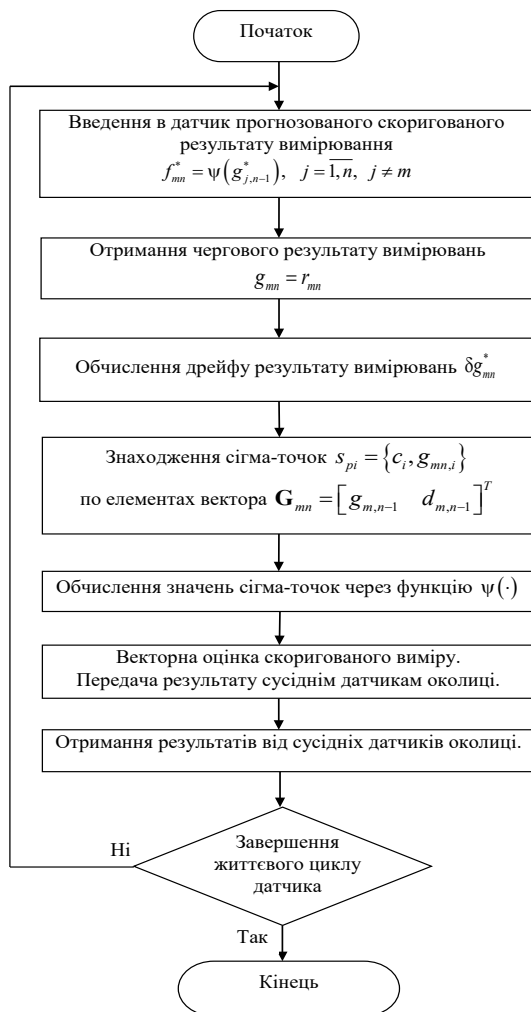
Рис. 4. Алгоритм корегування дрейфу параметрів m -го датчика
