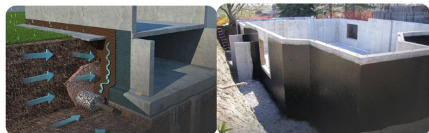
Рис. 3. а) гідроізоляція фундаменту; б) гідроізоляція цокольного поверху [4]
