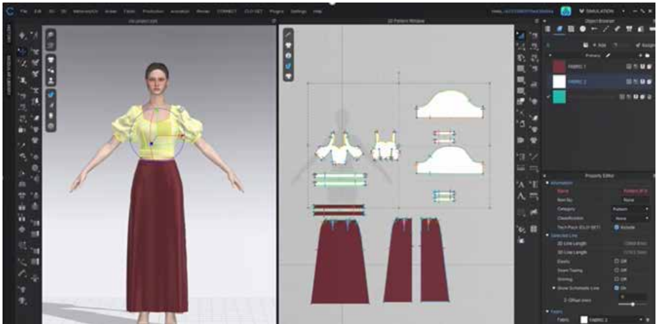
Рис. 2. 2D та 3D зображення спідниці та блузи в програмі clo3D (робота здобувача ОП «Технології легкої промисловості» Д. Павельчук)
